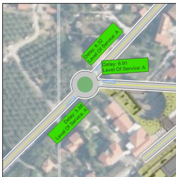
Slika 59: Povprečne zamude, nivo uslug in 95. percentil dolžine kolone po krakih v križišču K2; varianta V2 (z obvožno cesto), JK 2026.
