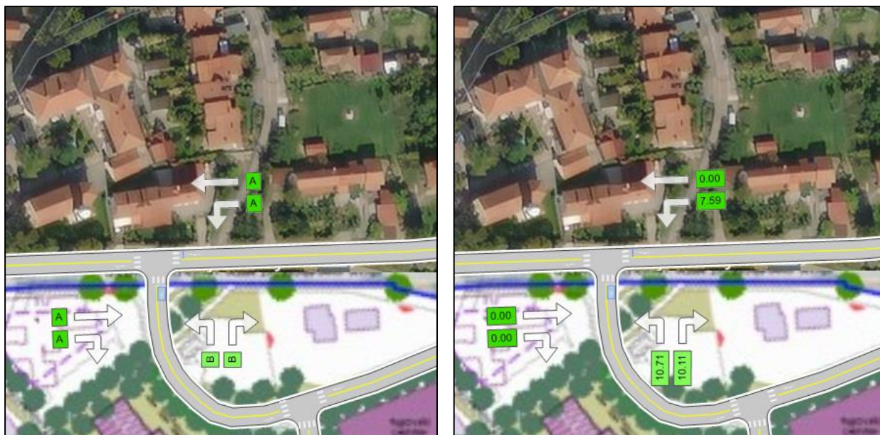
Slika 35: Levo: nivo uslug in 95. percentil dolžine kolone po smereh v križišču K3, desno: povprečna zamuda po smereh v križišču K3; varianta V1 (brez obvozne ceste), JK 2026.
