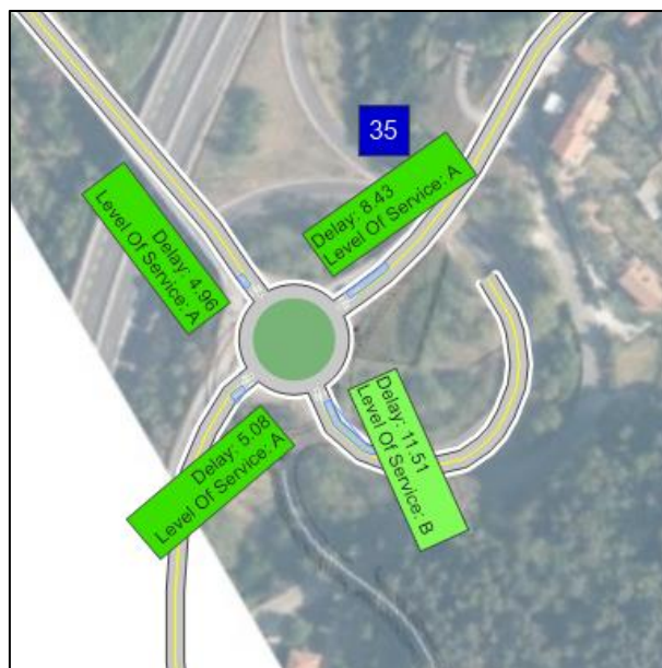
Slika 29: Povprečne zamude, nivo uslug in 95. percentil dolžine kolone po krakih v križišču K1; varianta V1 (brez obvozne ceste), PK 2021.
