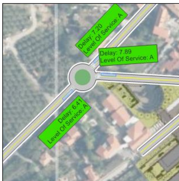
Slika 65: Povprečne zamude, nivo uslug in 95. percentil dolžine kolone po krakih v križišču K2; varianta V2 (z obvozno cesto), JK 2031.
