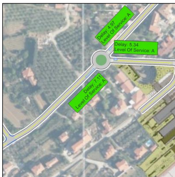
Slika 30: Povprečne zamude, nivo uslug in 95. percentil dolžine kolone po krakih v križišču K2; varianta V1 (brez obvozne ceste), PK 2021.
