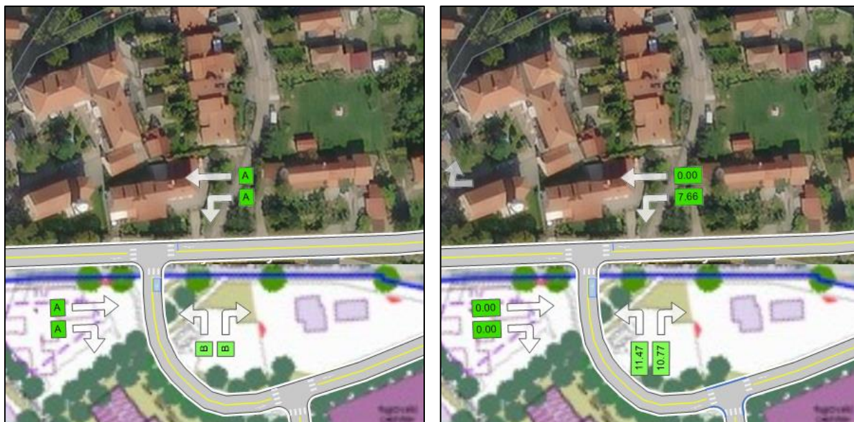
Slika 43: Levo: nivo uslug in 95. percentil dolžine kolone po smereh v križišču K3, desno: povprečna zamuda po smereh v križišču K3; varianta V1 (brez obvozne ceste), JK 2031.
