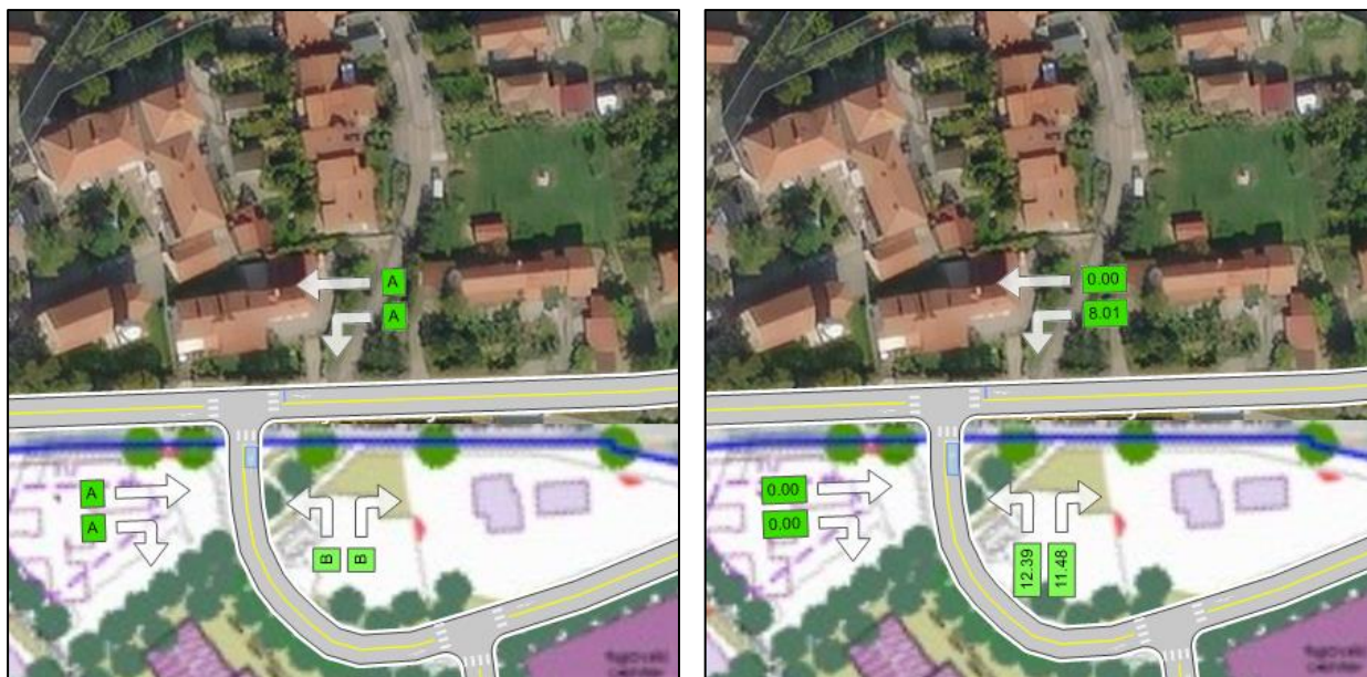
Slika 55: Levo: nivo uslug in 95. percentil dolžine kolone po smereh v križišču K3, desno: povprečna zamuda po smereh v križišču K3; varianta V1 (brez obvozne ceste), PK 2041.
