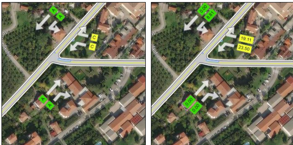
Slika 21: Levo: nivo uslug in 95. percentil dolžine kolone po smereh v križišču K2, desno: povprečna zamuda po smereh v križišču K2; obstoječe stanje, PK 2021.
