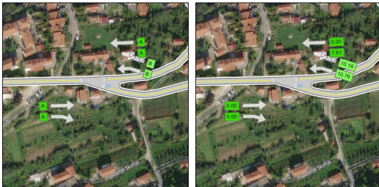
Slika 18: Levo: nivo uslug in 95. percentil dolžine kolone po smereh v križišču K3, desno: povprečna zamuda po smereh v križišču K3; obstoječe stanje, JK 2021.
