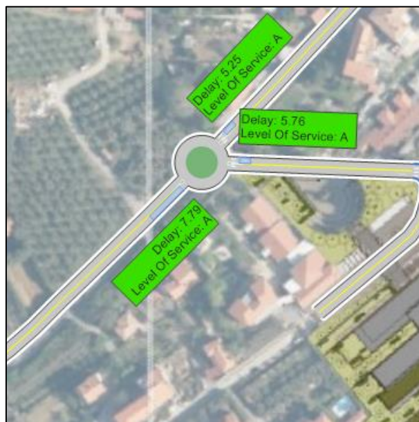
Slika 62: Povprečne zamude, nivo uslug in 95. percentil dolžine kolone po krakih v križišču K2; varianta V2 (z obvozno cesto), PK 2026.
