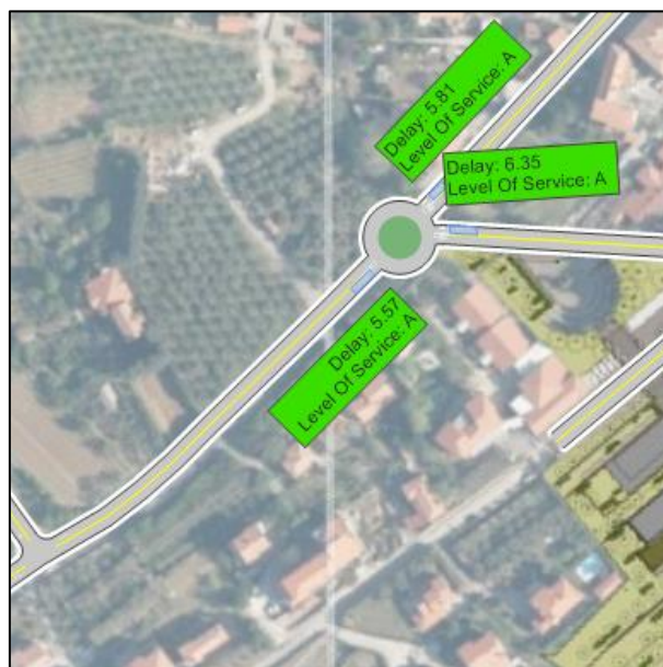
Slika 26: Povprečne zamude, nivo uslug in 95. percentil dolžine kolone po krakih v križišču K2; varianta V1 (brez obvozne ceste), JK 2021.
