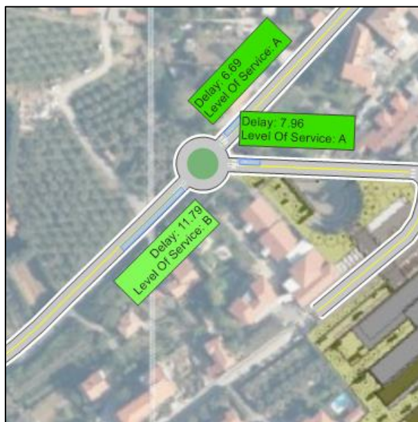
Slika 74: Povprečne zamude, nivo uslug in 95. percentil dolžine kolone po krakih v križišču K2; varianta V2 (z obvozno cesto), PK 2041.
