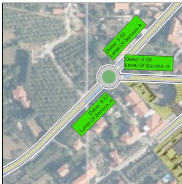
Slika 38: Povprečne zamude, nivo uslug in 95. percentil dolžine kolone po krakih v križišču K2; varianta V1 (brez obvozne ceste), PK 2026.
