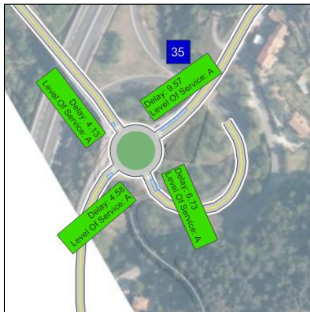
Slika 25: Povprečne zamude, nivo uslug in 95. percentil dolžine kolone po krakih v križišču K1; varianta V1 (brez obvozne ceste), JK 2021.
