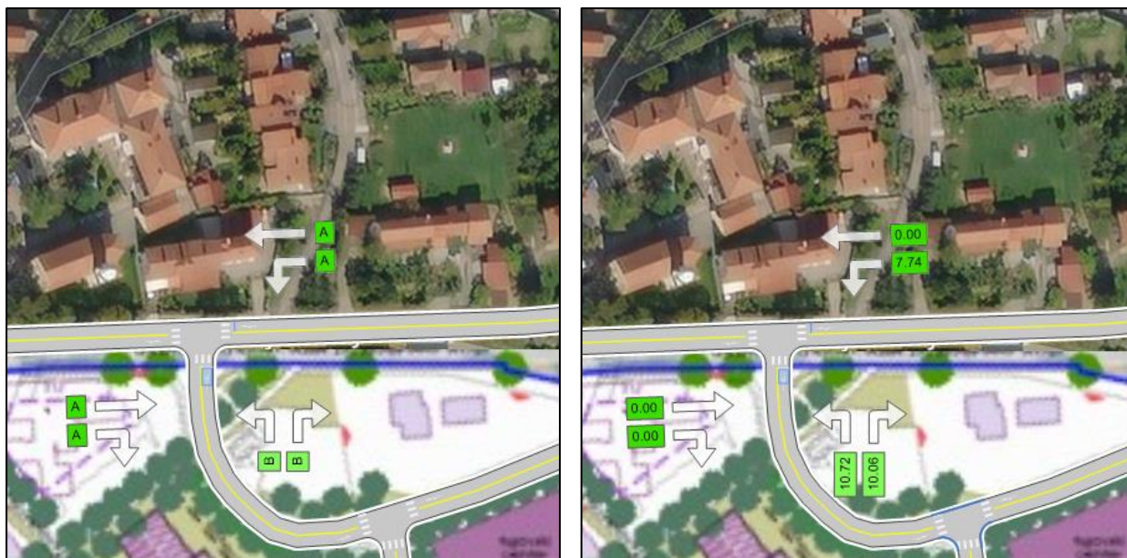
Slika 39: Levo: nivo uslug in 95. percentil dolžine kolone po smereh v križišču K3, desno: povprečna zamuda po smereh v križišču K3; varianta V1 (brez obvozne ceste), PK 2026.
