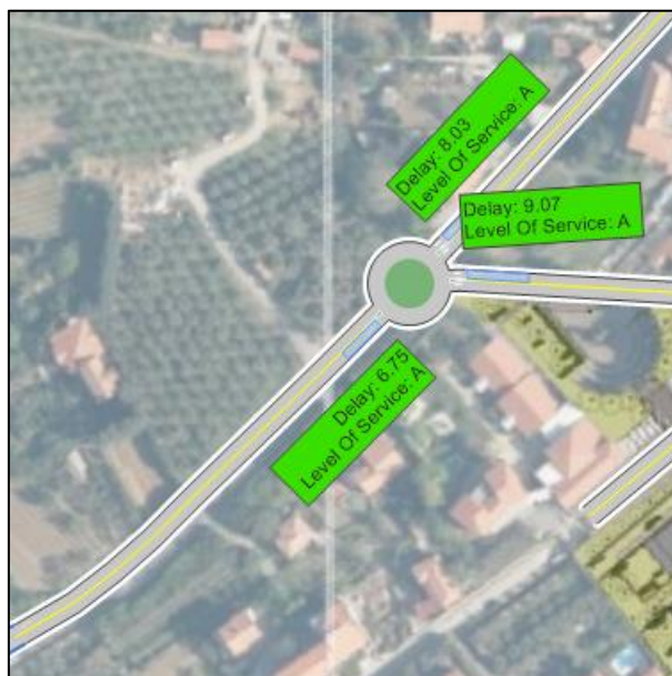
Slika 42: Povprečne zamude, nivo uslug in 95. percentil dolžine kolone po krakih v križišču K2; varianta V1 (brez obvozne ceste), JK 2031.
