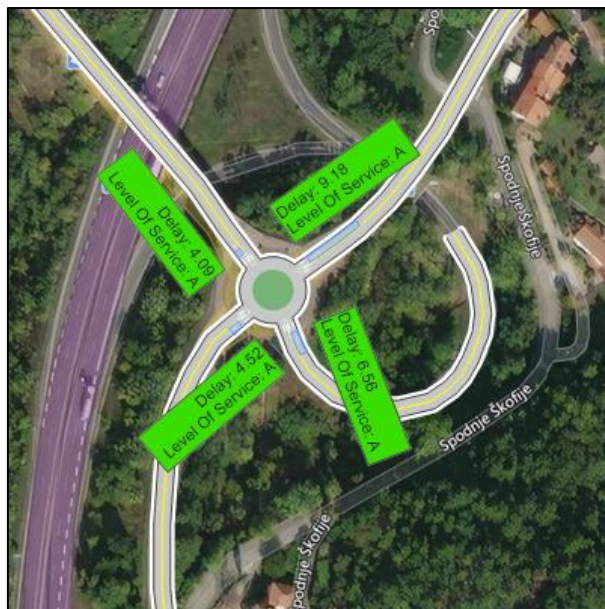
Slika 16: Povprečne zamude, nivo uslug in 95. percentil dolžine kolone po krakih v križišču K1; obstoječe stanje, JK 2021.
