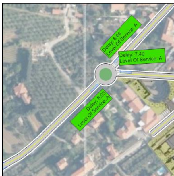
Slika 34: Povprečne zamude, nivo uslug in 95. percentil dolžine kolone po krakih v križišču K2; varianta V1 (brez obvozne ceste), JK 2026.
