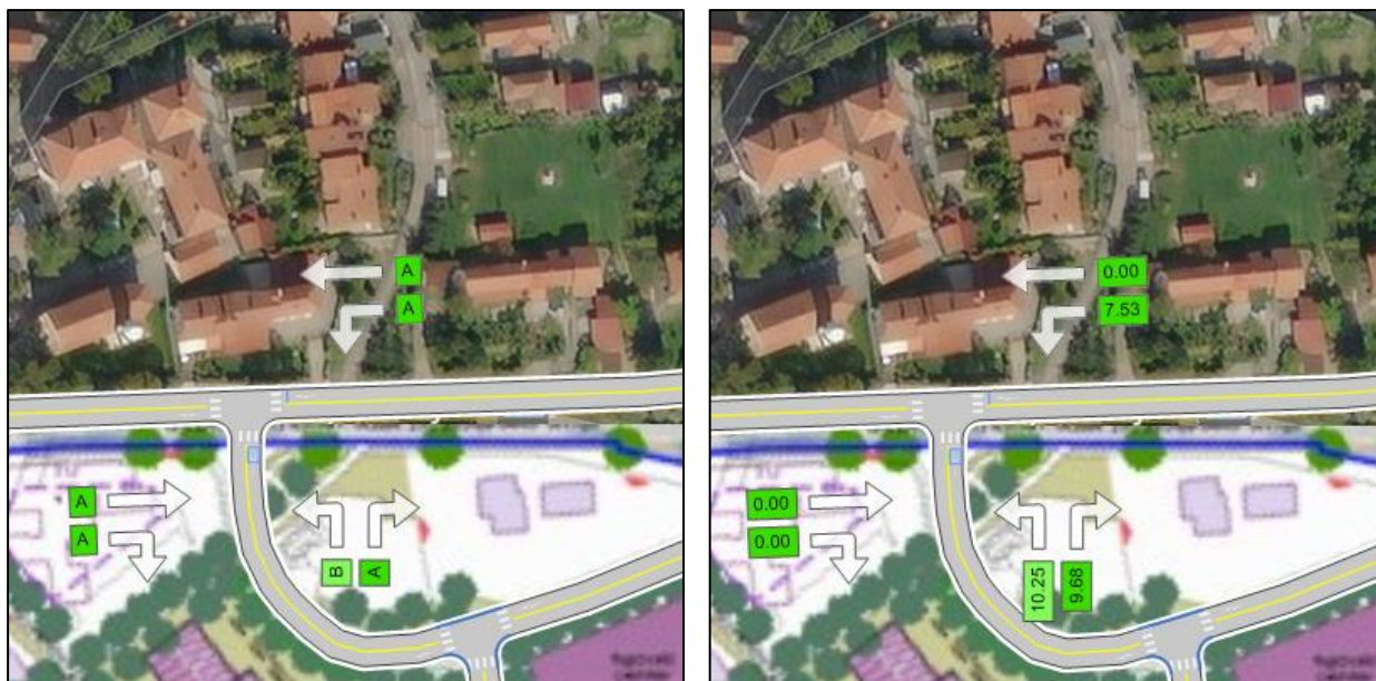
Slika 27: Levo: nivo uslug in 95. percentil dolžine kolone po smereh v križišču K3, desno: povprečna zamuda po smereh v križišču K3; varianta V1 (brez obvozne ceste), JK 2021.
