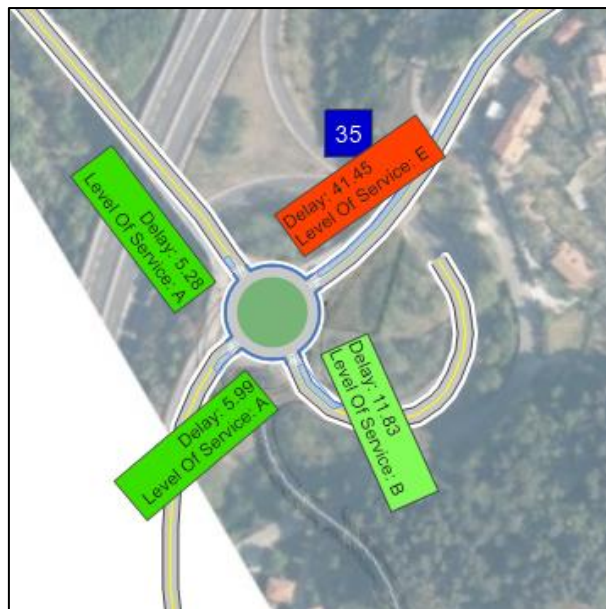
Slika 49: Povprečne zamude, nivo uslug in 95. percentil dolžine kolone po krakih v križišču K1; varianta V1 (brez obvozne ceste), JK 2041.
