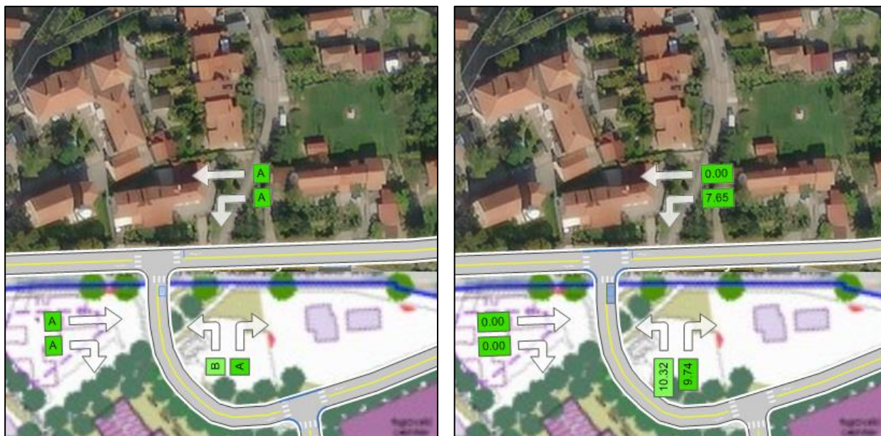
Slika 31: Levo: nivo uslug in 95. percentil dolžine kolone po smereh v križišču K3, desno: povprečna zamuda po smereh v križišču K3; varianta V1 (brez obvozne ceste), PK 2021.
