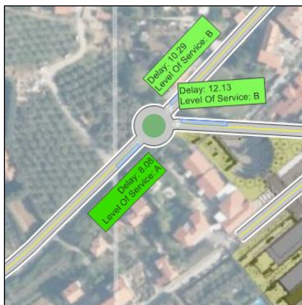
Slika 50: Povprečne zamude, nivo uslug in 95. percentil dolžine kolone po krakih v križišču K2; varianta V1 (brez obvozne ceste), JK 2041.
