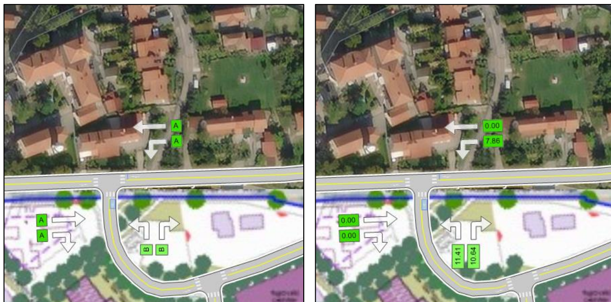
Slika 47: Levo: nivo uslug in 95. percentil dolžine kolone po smereh v križišču K3, desno: povprečna zamuda po smereh v križišču K3; varianta V1 (brez obvozne ceste), PK 2021.
