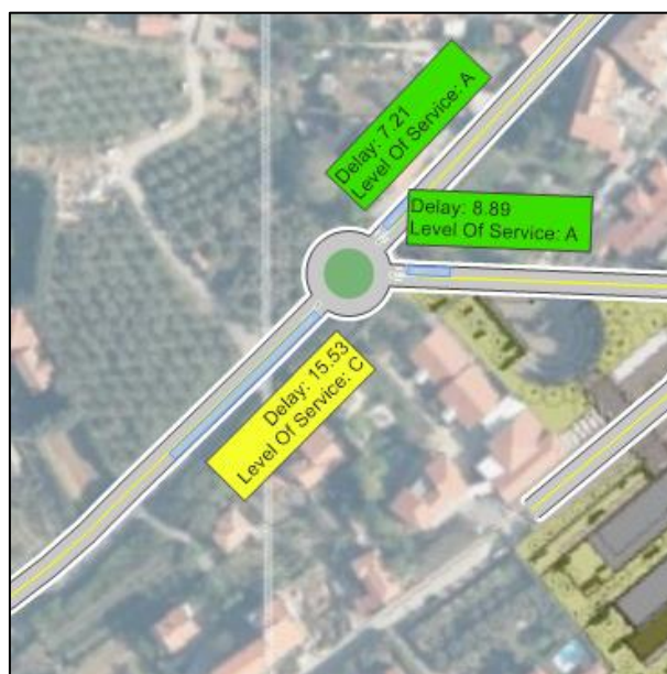
Slika 54: Povprečne zamude, nivo uslug in 95. percentil dolžine kolone po krakih v križišču K2; varianta V1 (brez obvozne ceste), PK 2041.
