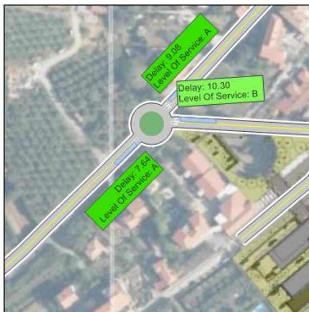
Slika 71: Povprečne zamude, nivo uslug in 95. percentil dolžine kolone po krakih v križišču K2; varianta V2 (z obvozno cesto), JK 2041.
