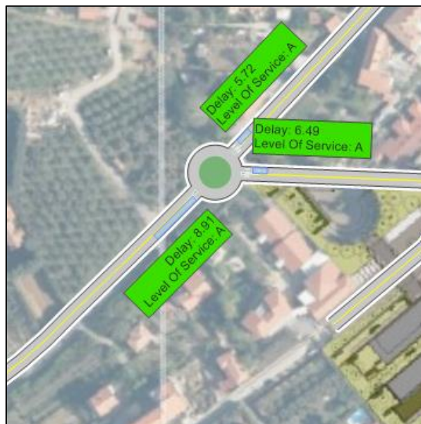
Slika 68: Povprečne zamude, nivo uslug in 95. percentil dolžine kolone po krakih v križišču K1; varianta V2 (z obvožno cesto), PK 2031.
