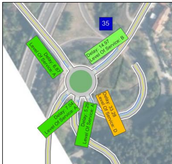
Slika 67: Povprečne zamude, nivo uslug in 95. percentil dolžine kolone po krakih v križišču K1; varianta V2 (z obvožno cesto), PK 2031.
