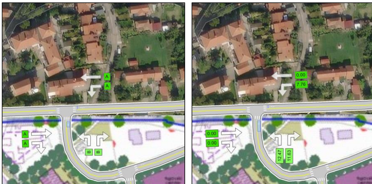
Slika 51: Levo: nivo uslug in 95. percentil dolžine kolone po smereh v križišču K3, desno: povprečna zamuda po smereh v križišču K3; varianta V1 (brez obvozne ceste), JK 2041.
