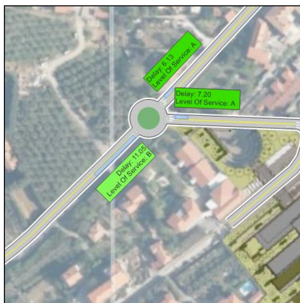
Slika 46: Povprečne zamude, nivo uslug in 95. percentil dolžine kolone po krakih v križišču K2; varianta V1 (brez obvozne ceste), PK 2031.
