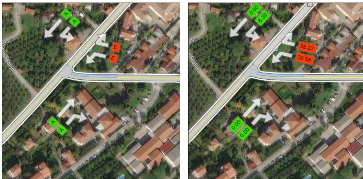
Slika 17: Levo: nivo uslug in 95. percentil dolžine kolone po smereh v križišču K2, desno: povprečna zamuda po smereh v križišču K2; obstoječe stanje, JK 2021.
