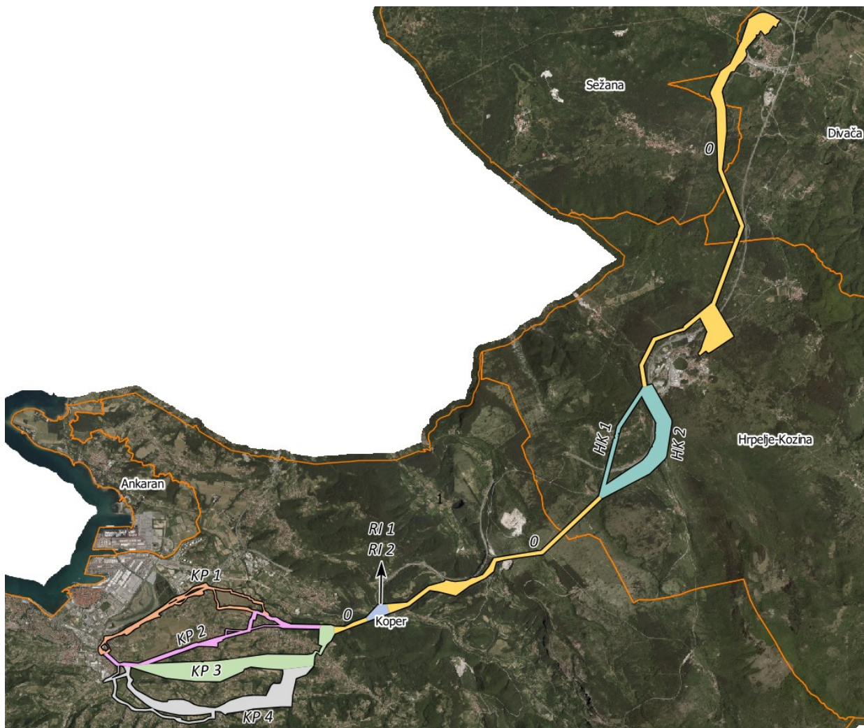
Slika 14: Različne variante koridorjev za umestitev trase elektroenergetskega voda.
